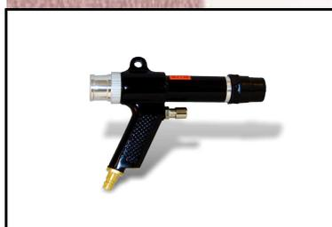
Venturi-Pistole zum extrem schnellen Befüllen, wobei Umgebungsluft angesaugt wird. Der Stausack kann nicht überfüllt werden. Die Pistole muss beim Befüllen vom Ventil entfernt werden.
