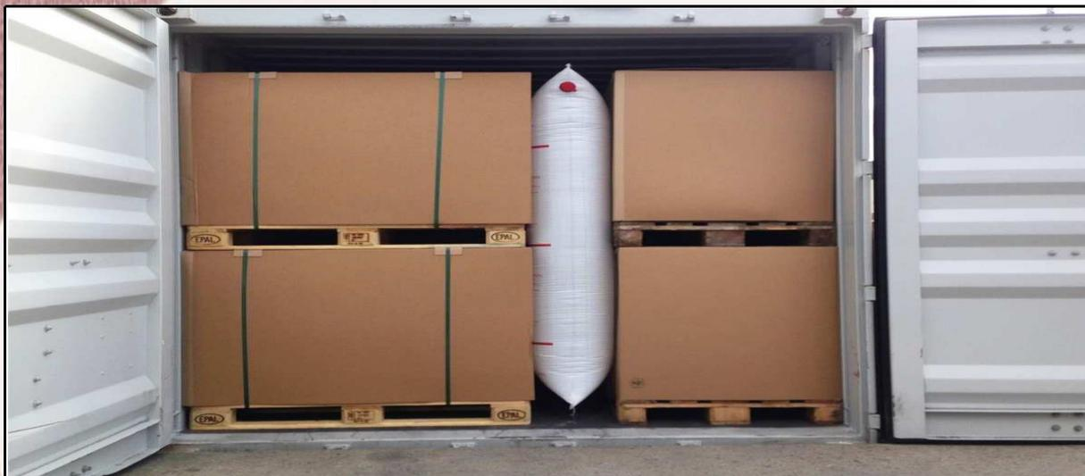
**Red Line Staupolstersäcke werden im Container zwischen der Ladung aufgeblasen und drücken die Packstücke gegen die Containerwand. Ein Bewegen der Ladung sowie Transportschäden werden somit verhindert.**
